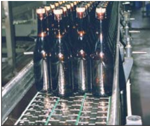
従来のガラスビン容器搬送 スチール製チェーン
